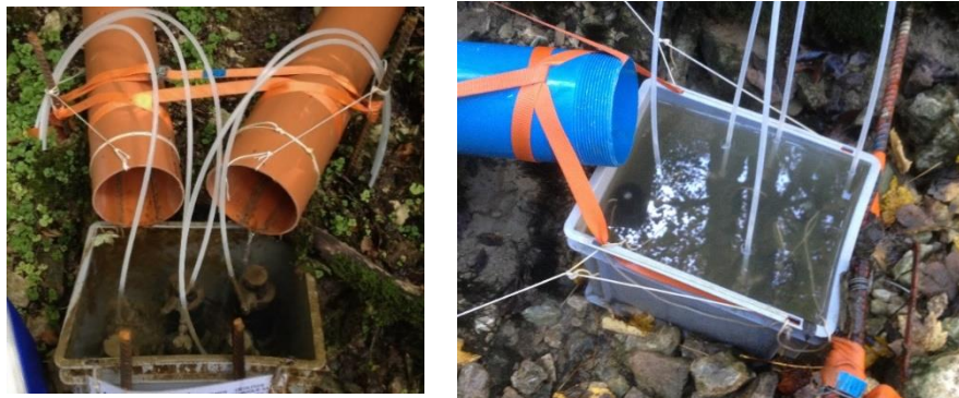
Figure 17 Exemple d'équipement de sources permettant d'assurer une profondeur d'immersion constante des capteurs passifs intégratifs de type Sorbicell. D'après (Renard et al. 2017).
