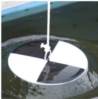
FIGURE 2.1 – *Disque de Secchi*
