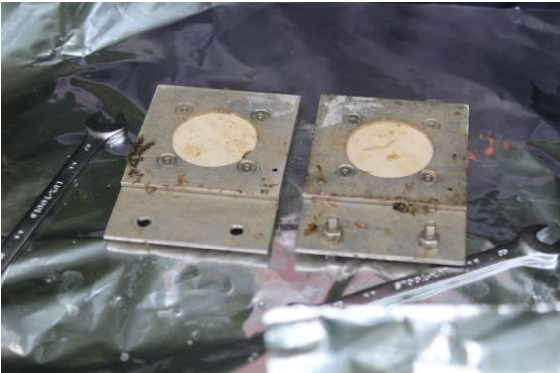
Etat des capteurs après 27 jours d'exposition
