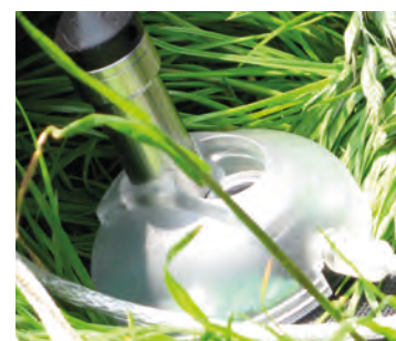
Photo 5. Sonde de pression/température sur son socle pour extraction de données.
