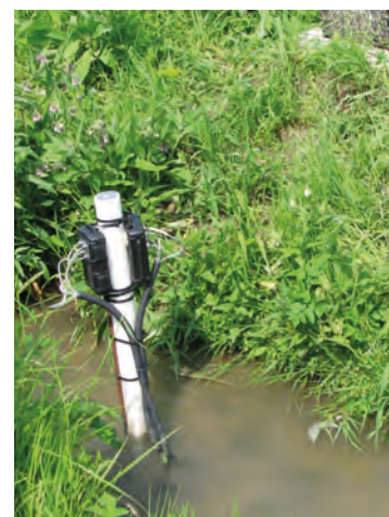
Photo 3. Dispositif Molonari sur un petit cours d'eau du bassin versant de l'Orgeval.
