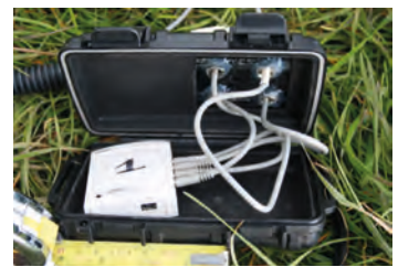
Photo 7. Sonde hyporhéique à quatre capteurs verticaux de température connectés à leur datalogger.
