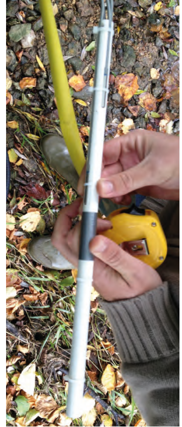
Photo 6. Sonde hyporhéique à quatre capteurs verticaux de température.
