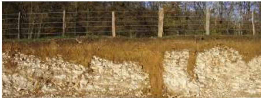
FIGURE II.5 – Hétérogénéité des profondeurs de sol au contact de la roche carbonatée (Photo E. Lucot)
