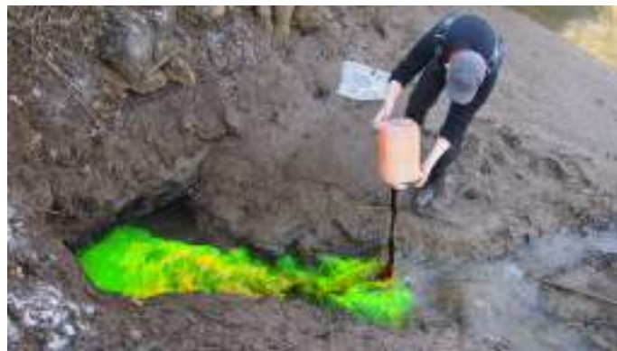
FIGURE I.4 – Injection d'un traceur artificiel à la perte de la Verne dans le système de Fourbanne.
