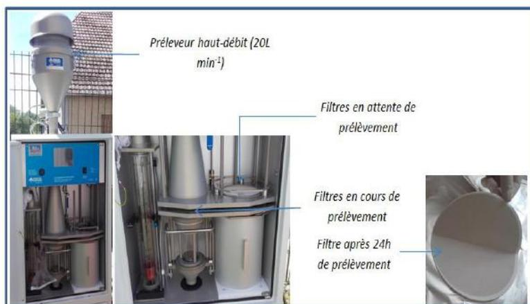
Figure 2.1 : Dispositifs de prélèvement des HAP de la station de Nancray
