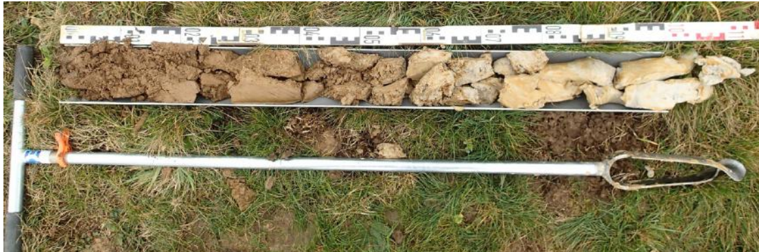
Figure 4. Reconstitution d'un profil de sol prélevé avec la tarière pédologique pour la description morphologique. Cliché É. Lucot
