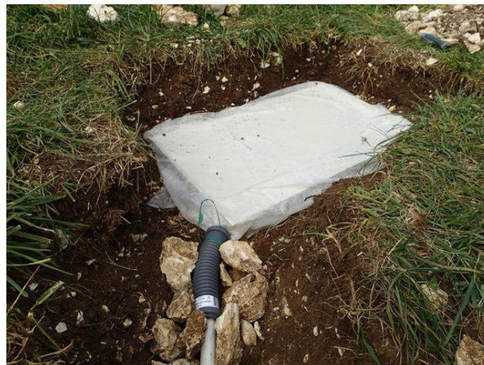
Figure 13. Plaque lysimétrique en cours d'installation dans un sol très superficiel. Au premier plan, le raccord du tuyau de récolte. Cliché É. Lucot.
