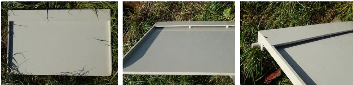
Figure 11. Plaque lysimétrique en polypropylène homopolymère PPH. Photographie de droite : raccord entre la gouttière et le tuyau. Clichés É. Lucot.
