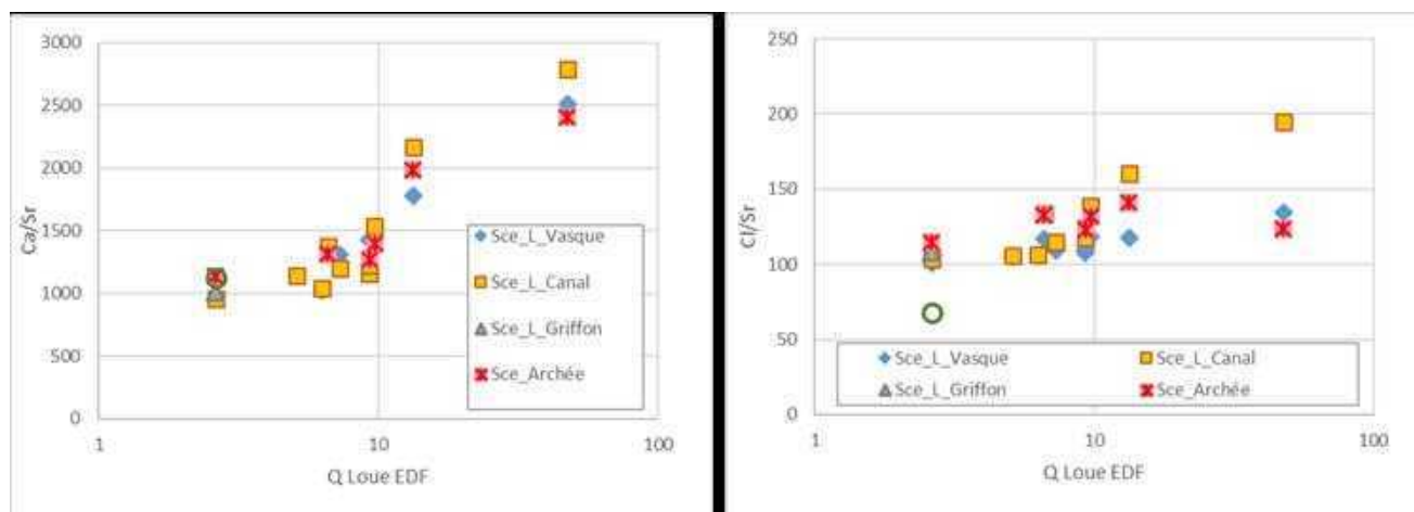
Figure 67. Evolution de la chimie des eaux des sources de la Loue, Baume Archée et Moulin Miquet en fonction du débit à la Loue vasque
