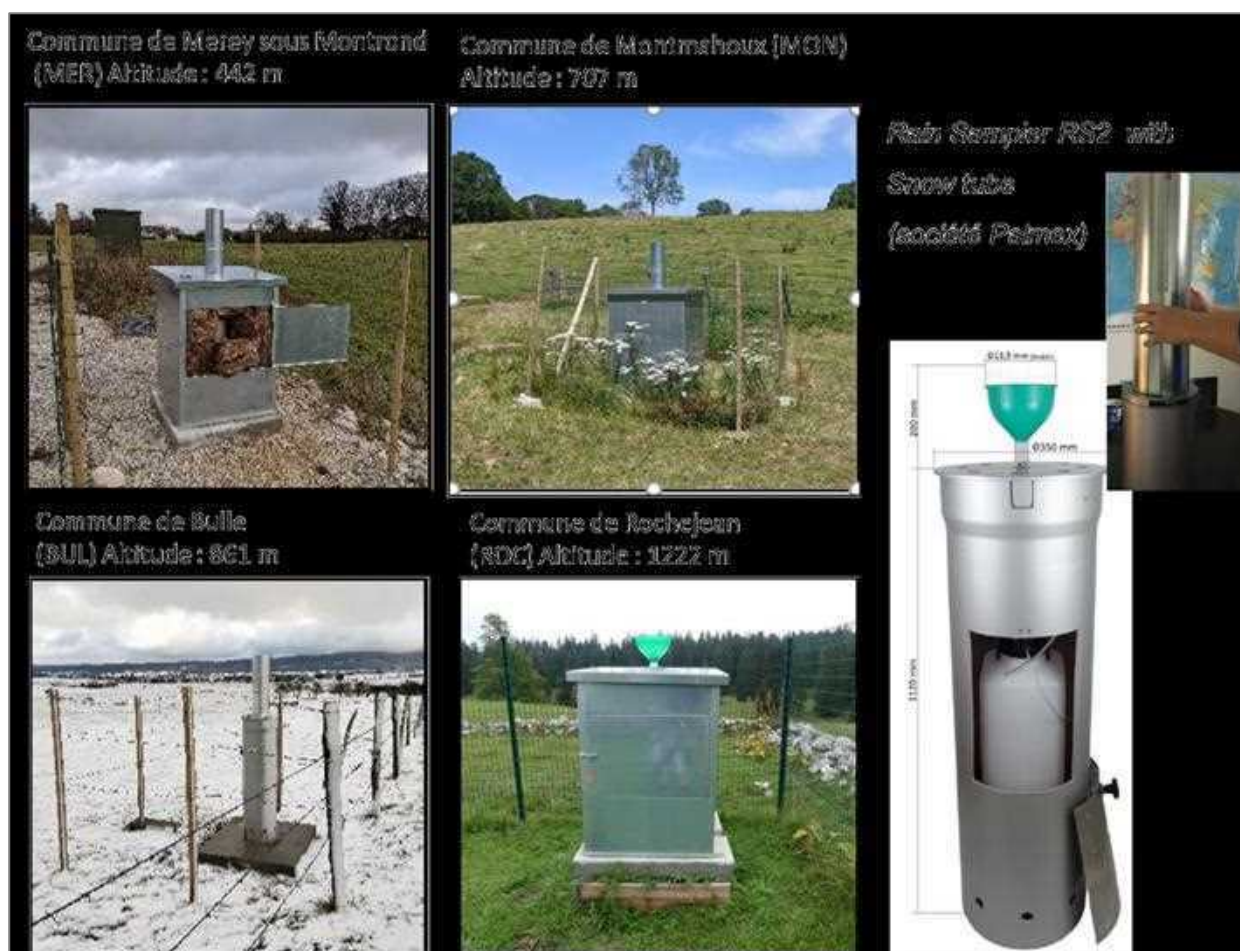
Figure 16. Vue des pluviomètres du réseau d'observation mis en place en septembre 2019.
