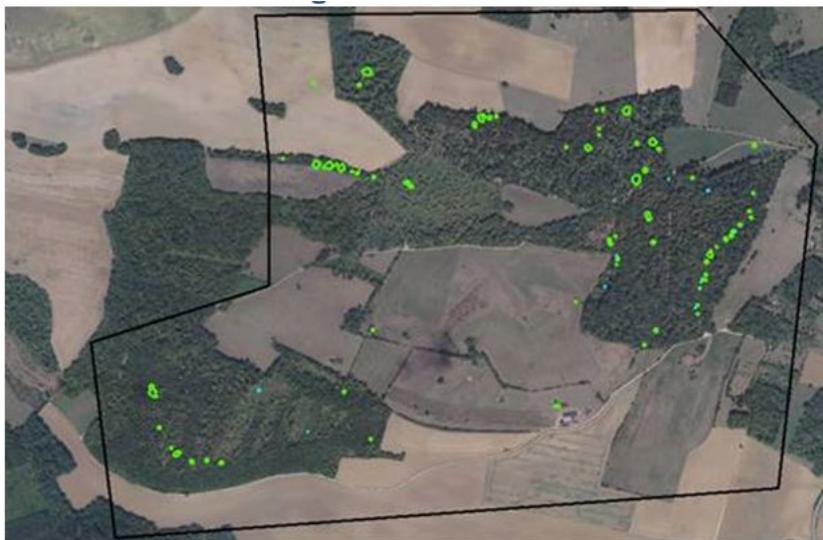
Figure 17 - Résultat de la détection dans un secteur de la Meuse, à partir du lidar, avec des isolignes espacées de 1 m
