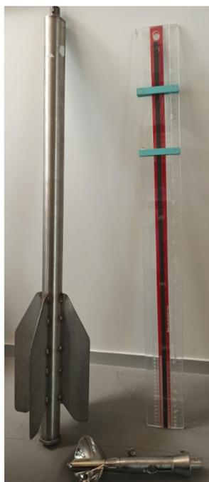
Tests en cours de la nouvelle perche de jaugeage transparente développée par l'INRAE – hydrométrie à bas coût des rivières en écoulements moyens (> 20 cm/s).
