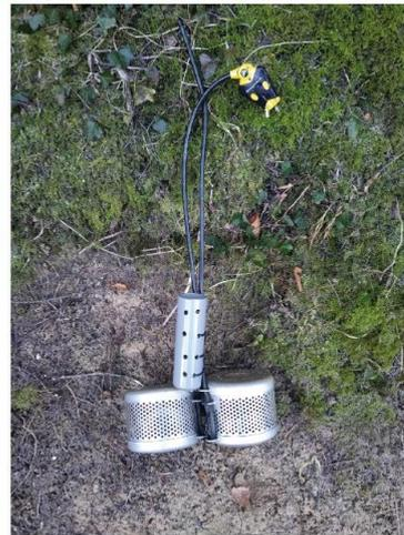
Dispositif permettant l'exposition des capteurs passifs
