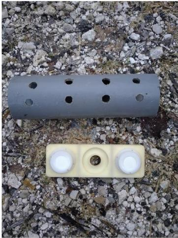
Capteurs DGT - échantillonnage des métaux
