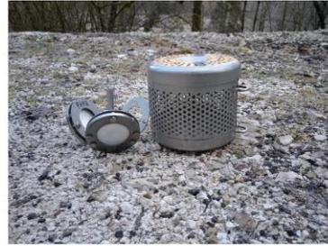
Exemple de capteurs passifs exposés dans la Bienne, ici les membranes POCIS et leur dispositif de protection
