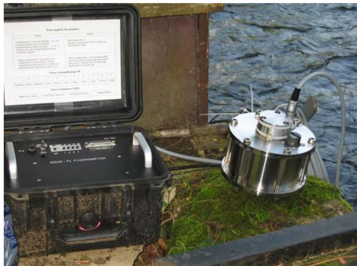
**Figure A.3 : Photographie du fluorimètre de terrain #194 GGUN-FL30 et de son boîtier d'enregistrement des données, installé à la source de la Noiraigue.**
