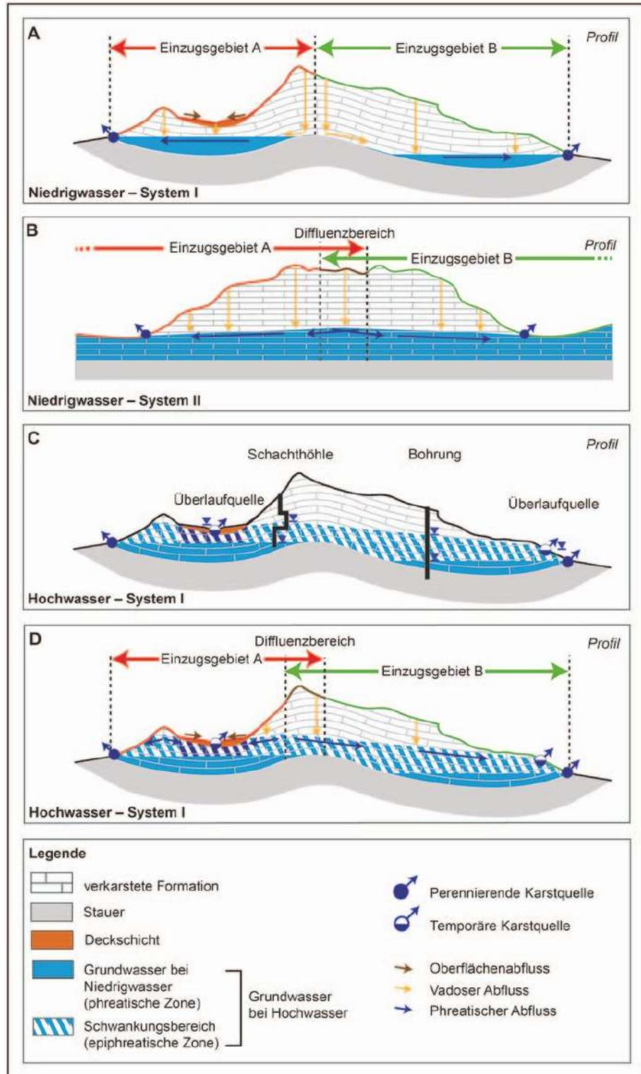
**Abb. 2** Konzeptuelles 3D-Modell eines Karstsystems aus der Anwendung des KARSYS-Ansatzes. Mithilfe aller verfügbaren Daten wird
