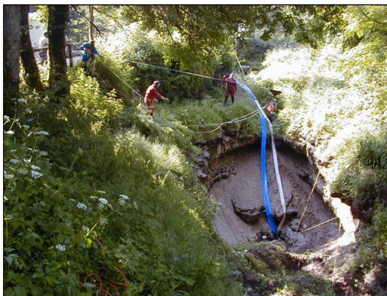
Photo 3 : Le puits de la Doye, vue générale lors de l'essai de pompage du 10 juin 2000 (Froissard, Gauthier, Reile)
