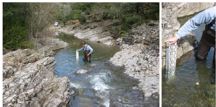
Figure 3 - Station de Panissière, le capteur de pression est installé dans un tube métallique crépiné, la station reste sans aménagement et l'échelle limnimétrique est amovible installée uniquement lors des interventions sur le terrain.
