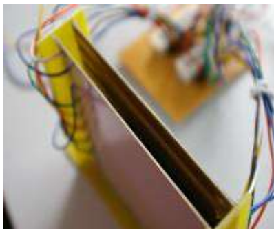
Figure 1 - À gauche : photographie du prototype chronotrappe résistive, À droite : mesure de la résistance pour les huit électrodes en fonction du volume de sédiment déposé dans le capteur.
