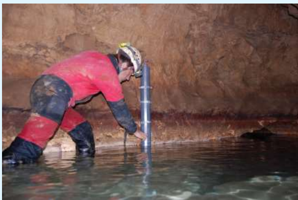
A la sortie de la zone siphonnante, un tube avec règle graduée pouvait accueillir les capteurs de hauteur d'eau. Notez la trace noire en paroi marquant le niveau de crues les plus fréquentes.
