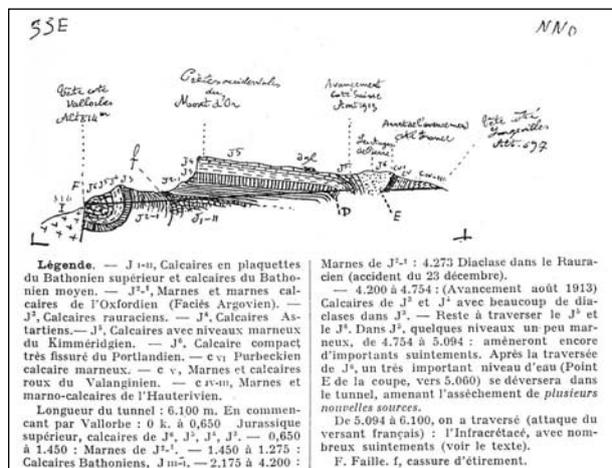
Figure 6. Coupe « historique » du percement du tunnel ferroviaire du Mont-d'Or (25) par Fournier (1910). Les travaux ont vidangé l'aquifère du Malm, dont la voûte anticlinale constitue un impluvium étendu.
