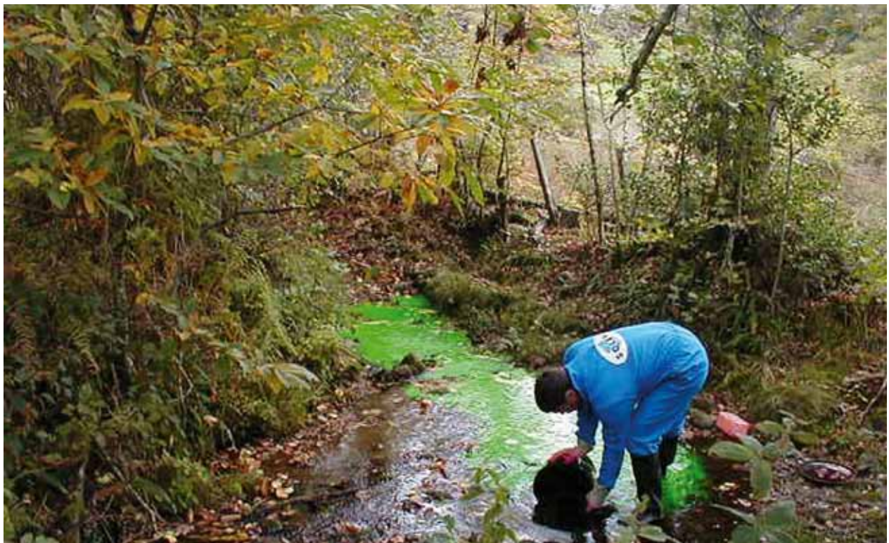
Injection de traceurs en amont d'une perte Photo GINGER
