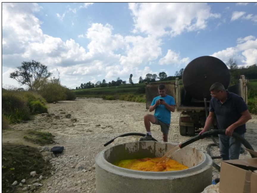
Photos 1 : Injection du colorant ARCON (17 09 2018)
