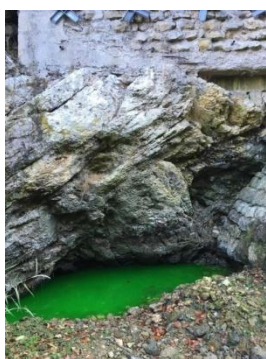
Photos 8 : Réapparition de la fluorescéine à la source de COLOMBIERE, REMONOT et PONT DU DIABLE
