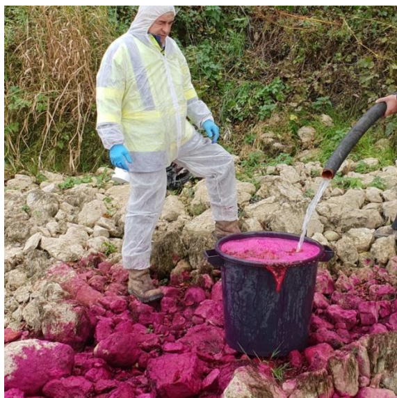
Photos 6 : Injection du colorant aval de MAISON DU BOIS le 24/10/2018 Détail de la stagnation des eaux colorées dans la gouttière Crétacée
