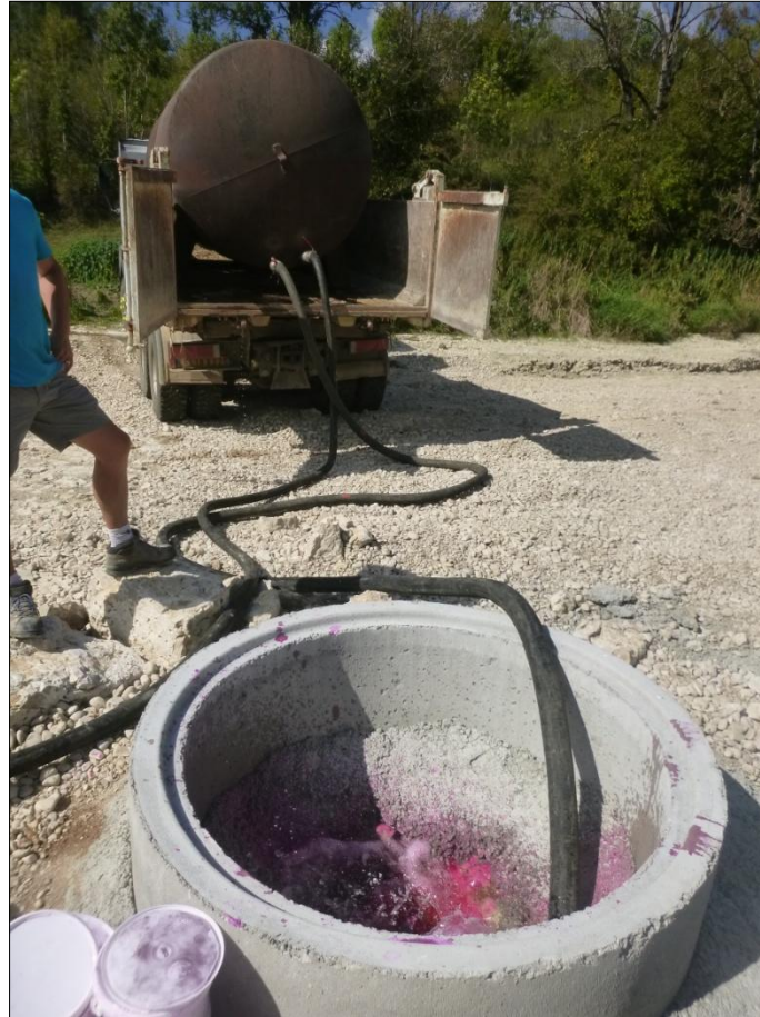
Photos 2 : Injection du colorant MAISON DU BOIS le 17/09/2018
