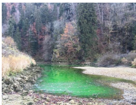
Photos 8 : Réapparition de la fluorescéine à la source de COLOMBIERE, REMONOT et PONT DU DIABLE
