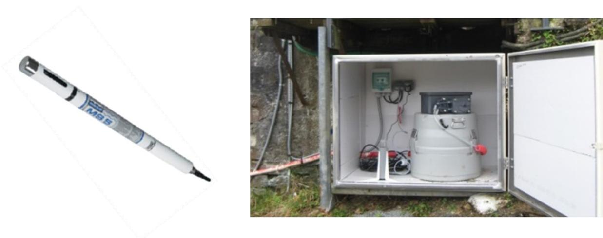
Illustration 5 – Instrumentation de base sur les stations QUARSTIC avec à gauche une sonde multi-paramètres (MS5 Hydrolab, OTT), et à droite un échantillonneur portable (3700, 24 flacons, ISCO).
