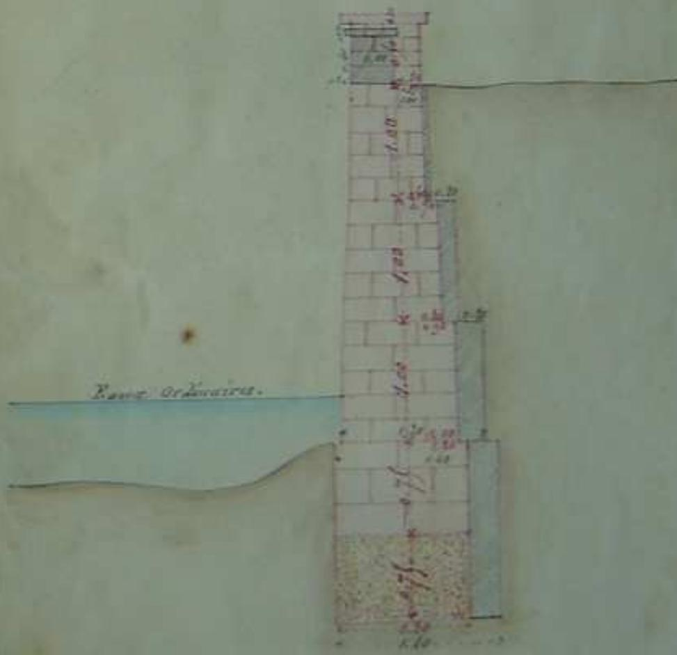
Coupe du mur de soutènement à construire
