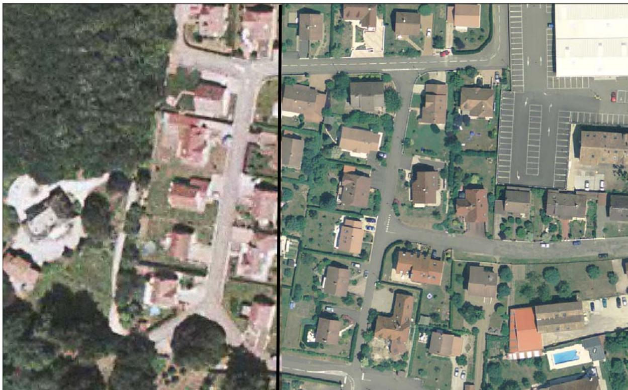
*Fig. 46 : Comparaison entre la Bd orthophoto IGN (à gauche) et l'orthophoto issu de la campagne de levés topographiques G2b de précision 20 cm (à droite). (Valdoie – 90)*
