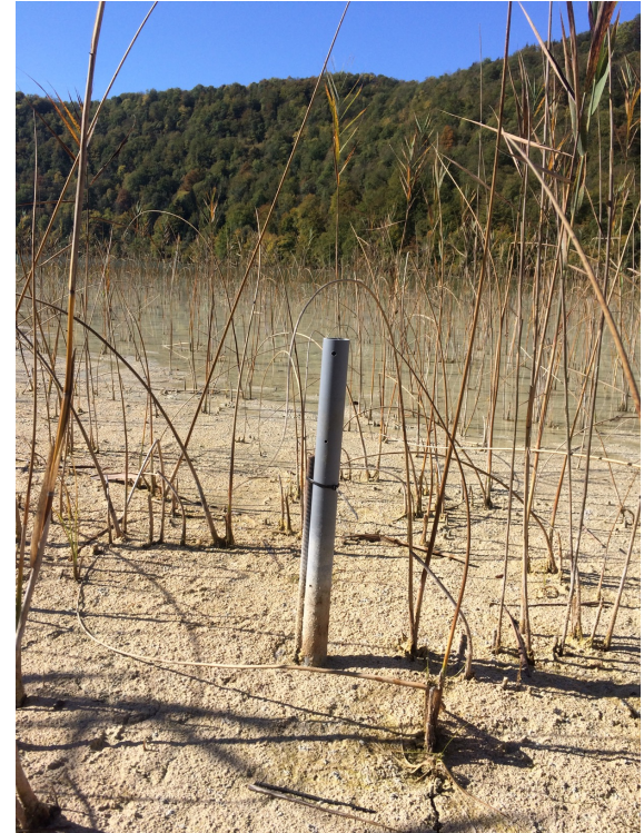
Tube piézométrique dans le lac du Val
