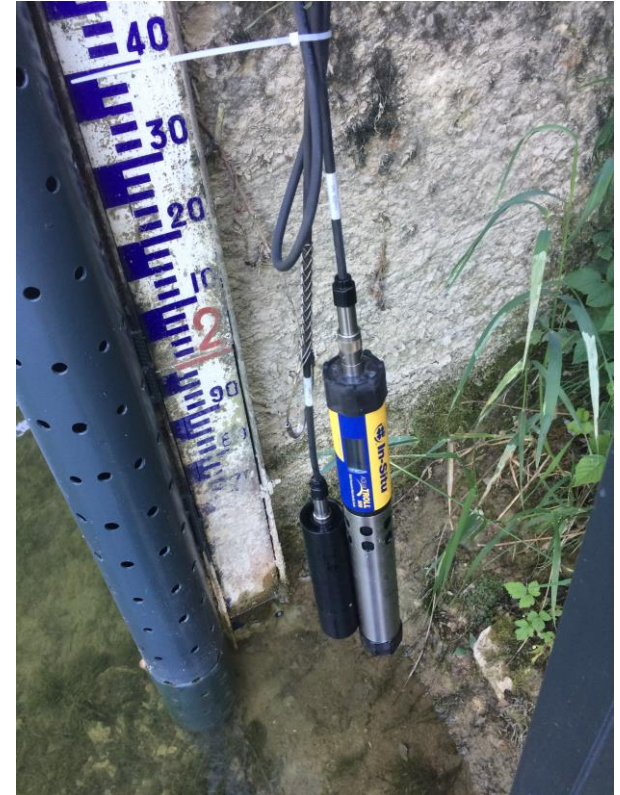
Capteur qualité/O 2 (taille réelle : 592 mm x 47 mm)
