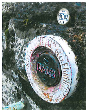
Repère de nivellement de l'IGN
